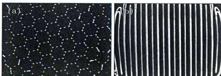
Abb. 1: Teilbild (a) zeigt die Oberflächenreflexionen eines hexagonalen Stachelmusters ohne Neigung des Feldes und einer magnetischen Induktion  $B_{\perp} = 20$  mT. Im Teilbild (b) sind die Reflexionen der flüssigen Kämmen zu beobachten. Hier ist das Feld um  $\alpha = 30^{\circ}$  geneigt, die magnetische Induktion beträgt  $B_{\perp} = 20$  mT. Die Tangentialkomponente des Feldes verläuft parallel zu den flüssigen Kämmen
